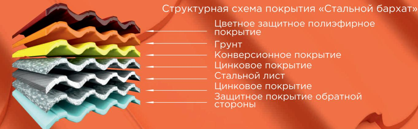
Многоуровневая защита обеспечивает высокое качество, долговечность эксплуатации и привлекательный внешний вид. Подлинность металлопроката гарантируется маркировкой, наносимой на поверхность обратной стороны с указанием вида («Стальной шелк» / «Стальной бархат»), толщиной металлопроката и массы цинка, толщины покрытия и даты производства
